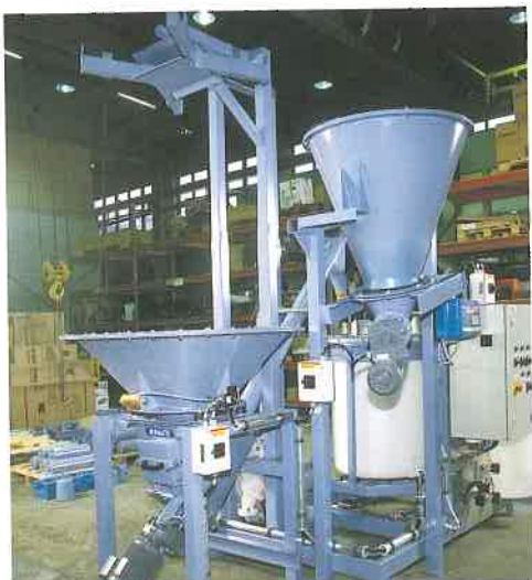
Latvialaiselle vaneritehtaalle toimitettiin jo kolmas liimaraaka-aineiden annostus- ja sekoituslaitteisto.
