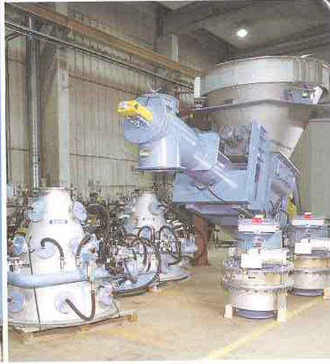
Espanjaan toimitettu kuparisulaton jatkuvatoiminen rikastesyötin kokoonpanovaiheessa Raute Precisionilla.
