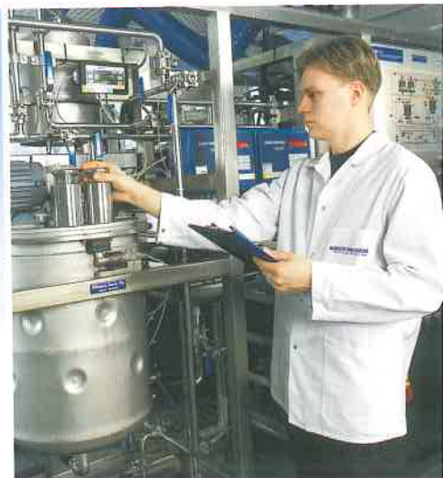
Nykyiset laatuvaatimukset edellyttävät jatkuvaa mittalaitteiden valvontaa. Huoltoteknikko Miikka Ijäs kalibroimassa säiliövaakoja VTT Energialla.
