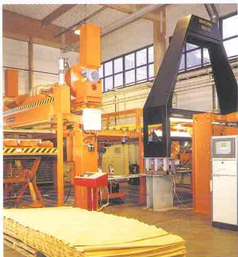
Rauten osakkuusyhtiön, konenäköteknologiaan erikoistuneen Mecanon kanssa yhteistyössä kehitetty viulunpaikkauslinja toimitettiin Suomeen.
