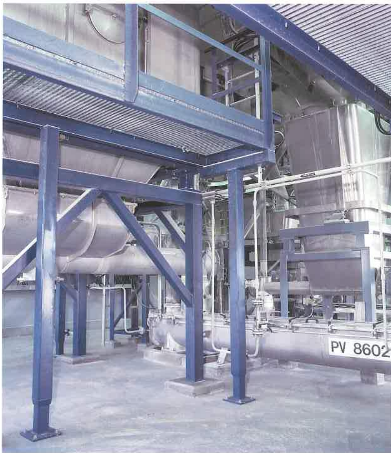
Loss-in-weight -syöttimet takaavat raaka-aineiden tarkan annostuksen jatkuvissa prosesseissa.
