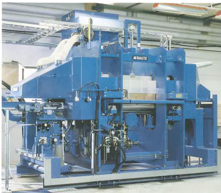
Parkettiteknologiamme ydinkoneita on HF (High Frequency) -tekniikkaan perustuva puristin. Lyhyt puristusaika takaa korkean kapasiteetin.
