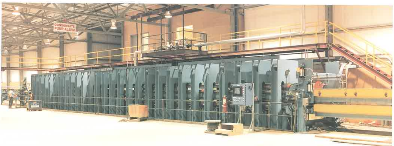
Viilupalkki puristetaan kuumapuristimessa. Tuote- ja kapasiteettivaatimusten mukaan voidaan valita 1-, 2-, 3- tai monivälinen puristin.
