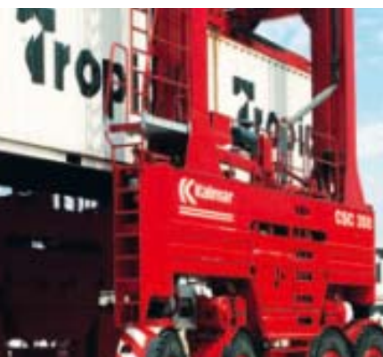
15 metriä korkea Kalmar-konttilukki voi pinota kontteja neljään kerrokseen.
