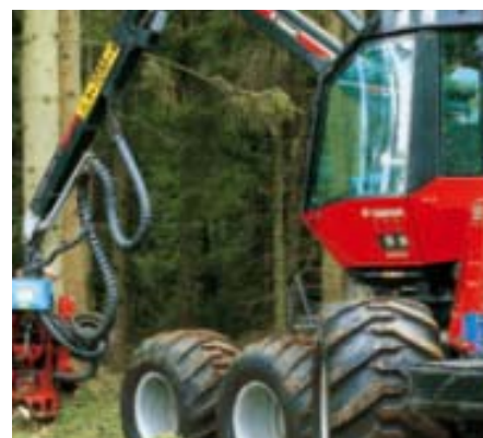
Valmet-metsäkone kaataa, karsii ja katkoo rungot määrämittaen ennalta määritellyn käyttötarkoituksen mukaisesti alle minuutissa.
