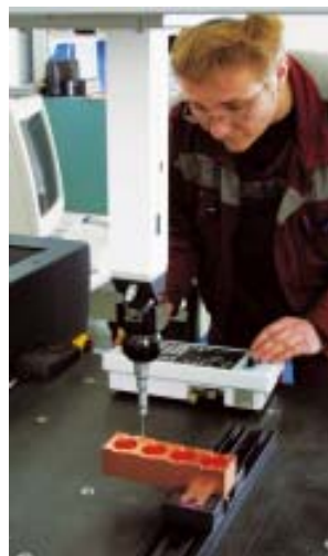
Koneistettujen tuotteiden laadunvarmistusta tehdään mm. koordinaattimittauskoneella.
